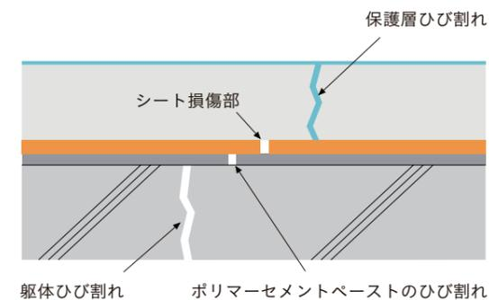
そのため、サンエーシート防水層にヒューマンエラーなどによる不具合があったとしても防水層内に水が浸入しません。また、万が一漏水した場合でも、RCの建物であればその真上に不具合があることが判るため、漏水箇所が比較的容易に特定できます。
