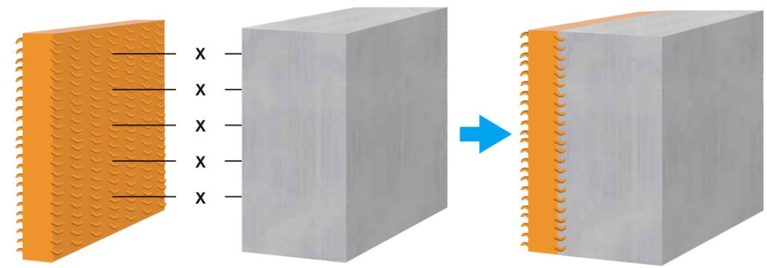
セメント成分がシート表面に存在する官能基「X」と化学反応を起こし、さらに細かい起毛の間に入り込み毛を掴んで密着するため、シートとコンクリートの水密性が高まります。
