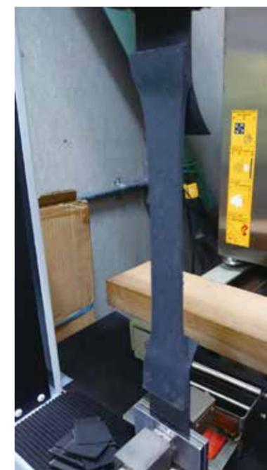
サンエーボンド PU + サンエーシート接合引張強度試験
